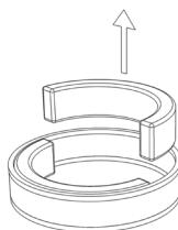
**⚠** In ieder vetfilter bevinden zich 2 half ronde zwarte monoblock filters. Neem de 2 half-ronde monoblock filters uit het aluminium vetfilter!
