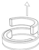
**!** Chaque filtre à graisses contient 2 filtres Monoblock noirs de forme semi-circulaire. Retirez les 2 filtres Monoblock semi-circulaires de chaque filtre à graisses en aluminium.
